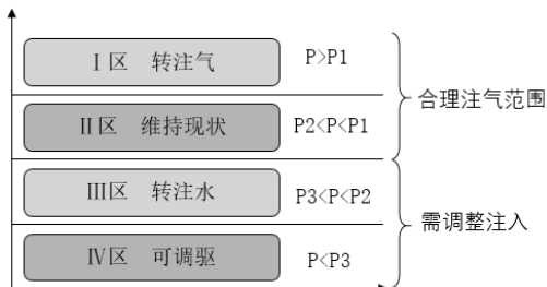
图 1 ZJD 油田气水交替模式图
