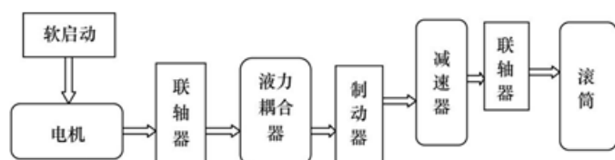
图 1 带式输送机驱动装置结构组成
