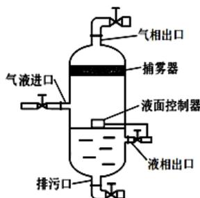
图1 立式重力气液分离器
