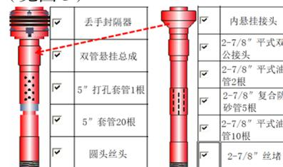
图 5 泵下一级防沉砂内管结构
