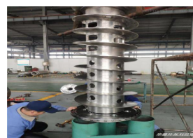
图2 推料式离心机轴承维护示意图
