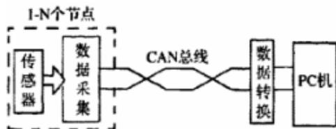
图 1 支架压力检测系统结构框图
