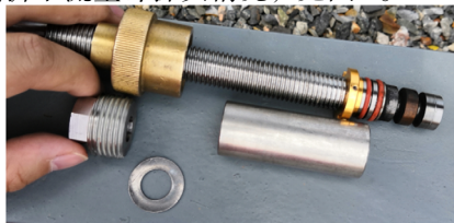
图 3 拆卸完成的探头情况
