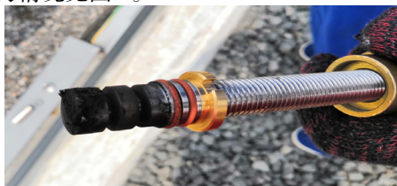
图 2 流量计探头脏污
