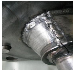
图4 加强定位套次改进设计故障裂纹
