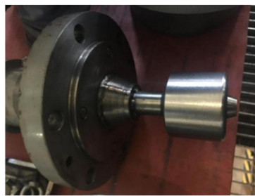
图3 加强定位套次改进后的设计
