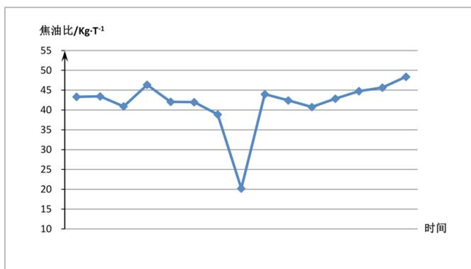
图3 釜温 94-94.5°C 对应时间——焦油比曲线
