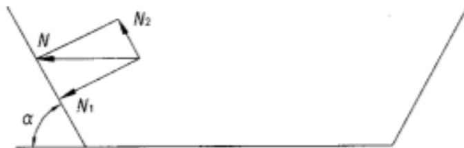
图 1 输送带与机架间的力学关系
