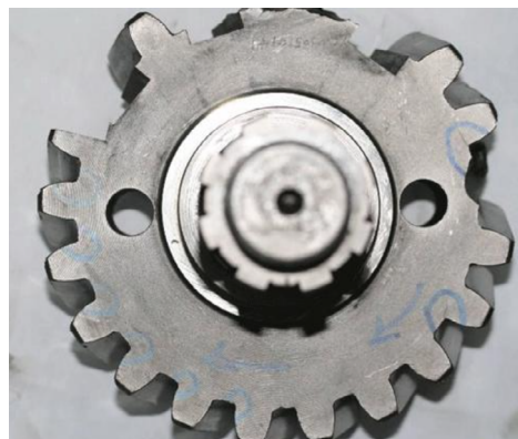
图3 齿轮局部断裂示意图
