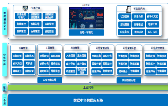
图4 智能矿井运维平台架构
