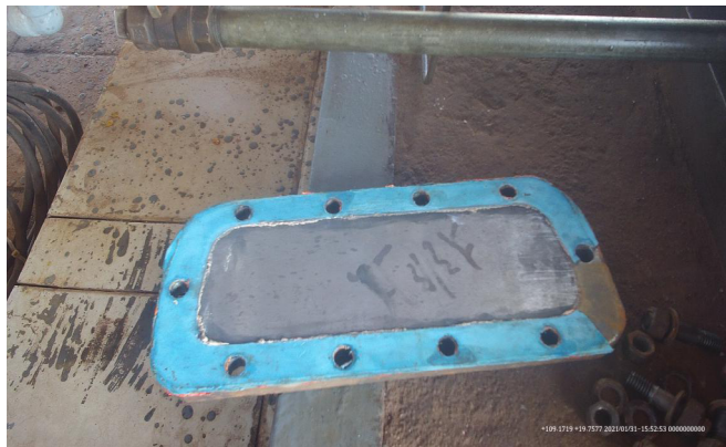
图2 气阀盖垫子撕裂
