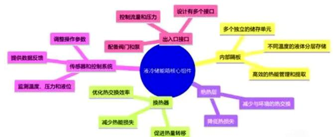
图1 液冷储能箱核心组件
