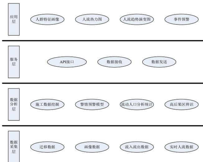
图 1 油气长输管道高后果区辨识系统架构
