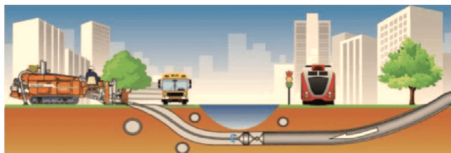
图1 定向钻施工回拖敷管过程示意图
