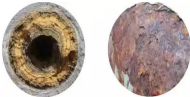
图1 结垢和腐蚀现象
