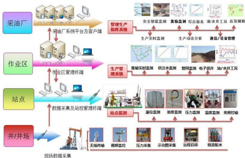
图1 冀东油田生产数字化
