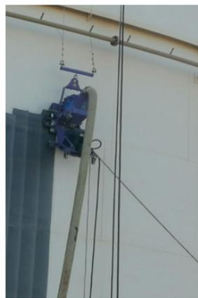
图3 爬壁除锈机器人的应用
