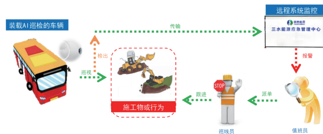
图 1 基于动态 AI 视觉巡检预警系统工作模式示意图
