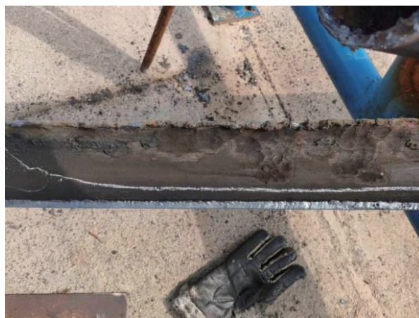
图4 油管内壁腐蚀坑
