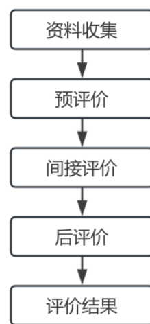
图2 管道外腐蚀检测流程
