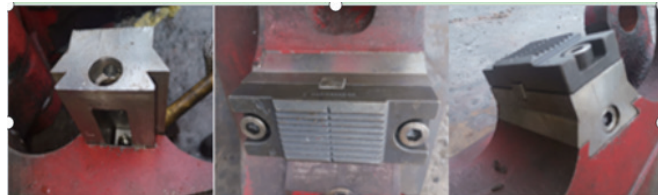
图4 改造加工制作后的上夹紧臂、过渡块与上钳牙的组装图
