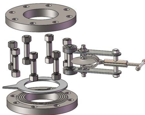
图 1 法兰螺栓切割工具示意图 (右侧为切割工具)
