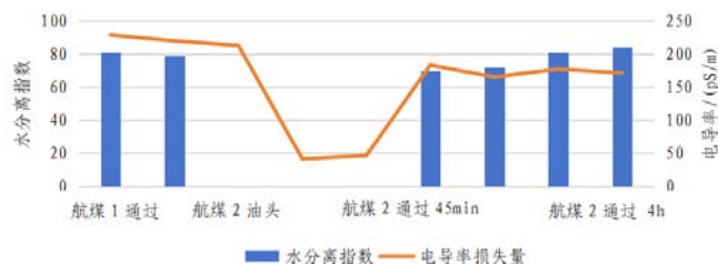
图 2 水分分离指数与电导率损失量对应关系
