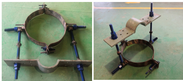
图 4 清管球收发球器端盖安全防护装置实物图
