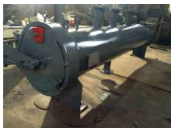
图1 清管球收发球器图
