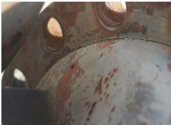
(c) 阀杆侧阀体法兰 图 1 失效阀门
