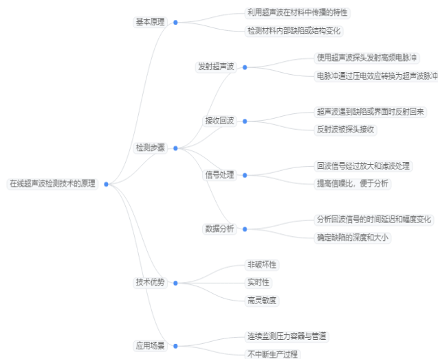
图 1 在线超声波检测技术原理
