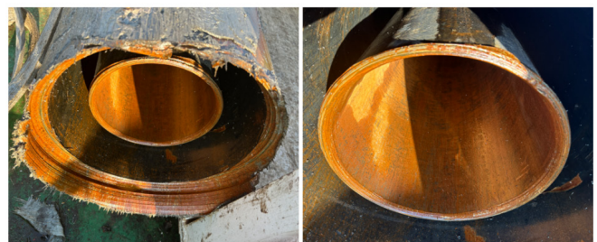
图 2 出井后的双层套管割口
