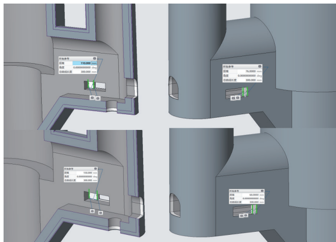
图 4 返料风门定位偏差测设图
