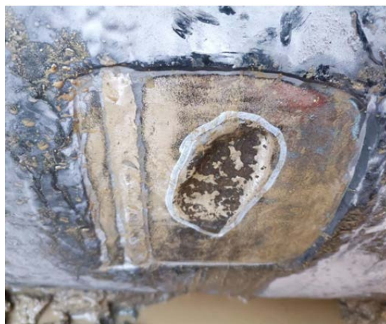
图 5 管道受直流干扰腐蚀样貌
