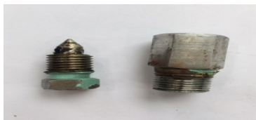
图 2 双转子流量计排气阀分解图
