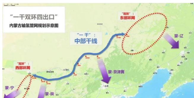
图 1 “一干双环四出口”内蒙古输氢管网规划示意图
