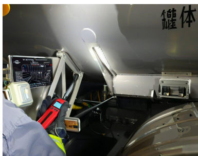
图1 监测罐体泄漏过程
