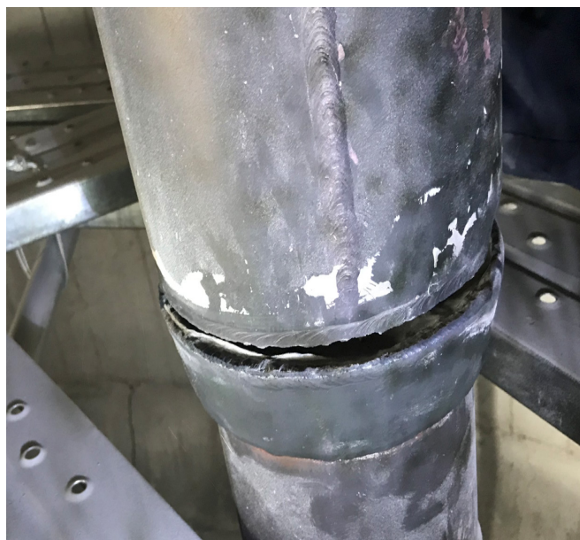
图3 料腿与灰斗连接焊缝径向截面断面图
