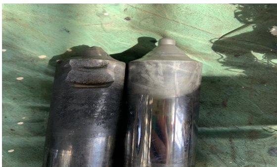
图 1 磨损阀芯与新阀芯对比
